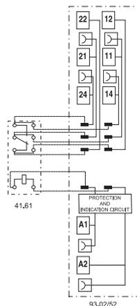
\* Для токов >10 А, клеммы контактов надлежит подключить параллельно (21 с 11, 24 с 14, 22 с 12).
