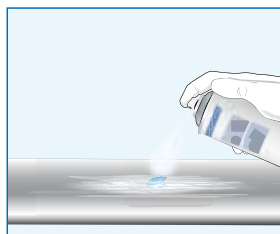
Загерметизировать отремонтированный участок с помощью Цинк-Спрея
