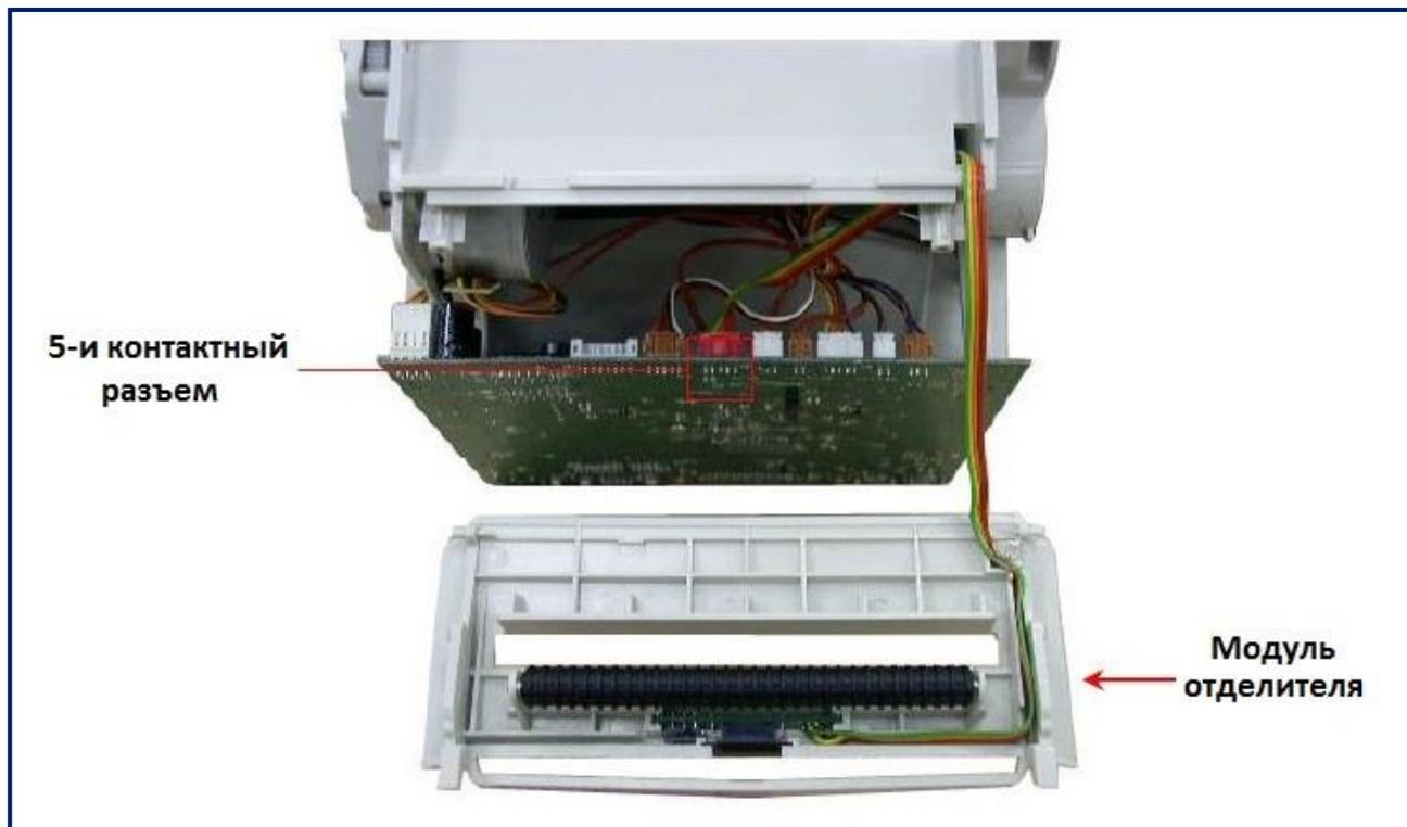
После подключения зафиксировать модуль отделителя на передней панели и произвести монтаж нижней части корпуса принтера. Порядок монтажа обратный описанному в пункте №1.
