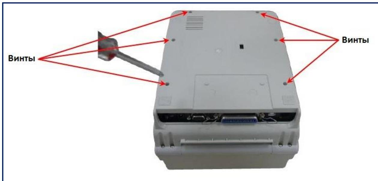
Снять переднюю панель принтера, потянув ее вверх. На ее место будет установлен модуль отделителя.
